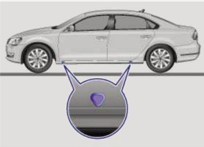
Posizionare il cric in modo che sia perpendicolare all'alloggiamento anteriore o posteriore, previsto sotto il longherone, come indicato in figura.
